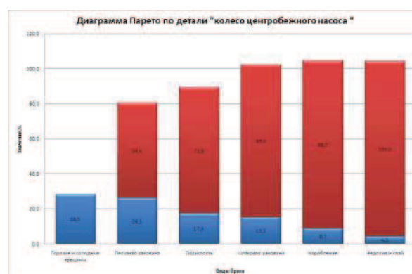
Рисунок 3 – Диаграмма Парето по видам брака для детали колесо центробежного насоса
