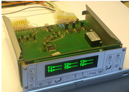
Рис. 2. Климатический контроллер управления отопительным устройством кабины водителя автобуса
