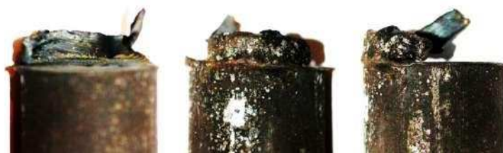
Рисунок 2 – Фотография нижнего заусенца на торце трубы диаметром 58 мм, после реза классической пилой
