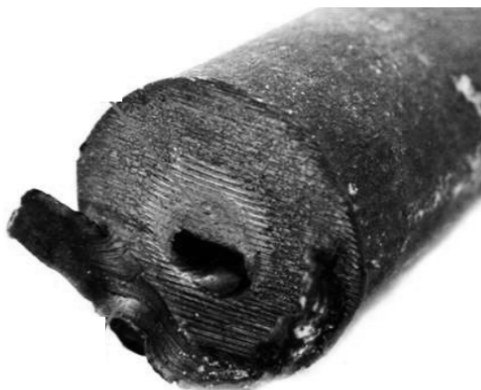
Рисунок 1 – Торец углеродистой трубы после горячего реза на линии пресс 2000 ТПЦ-2 АО «ВТЗ»
