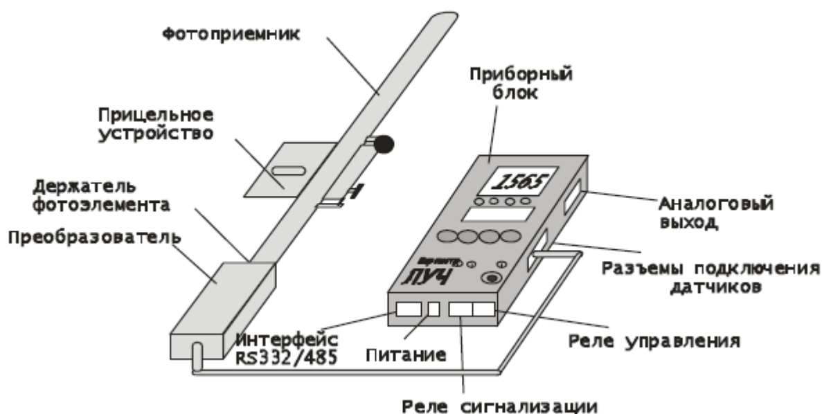
Рис. 3. Датчик вспомогательной технологической оснастки с лазерным пирометром ЛУЧ-СМ для определения температуры заготовки в зоне резания
