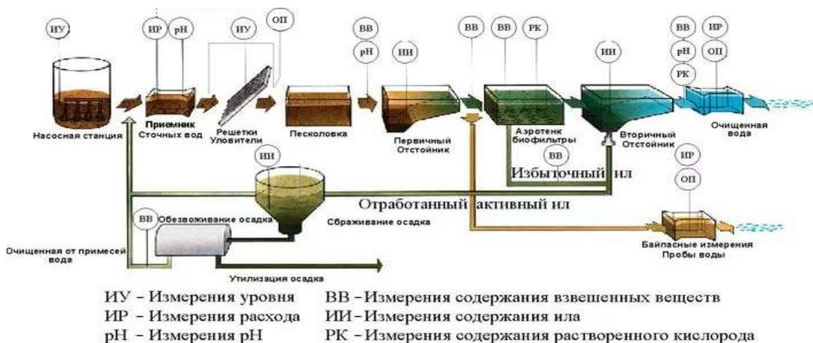
Рис 2. методы очистки сточных вод с помощью вторичного отстойника.
