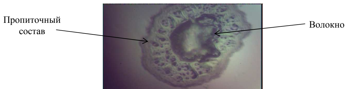
Рис. 1. Поперечный срез обработанного полиэфирного волокна, х 400
