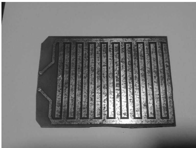
Рисунок 1 – Рабочий элемент емкостного датчика влажности
