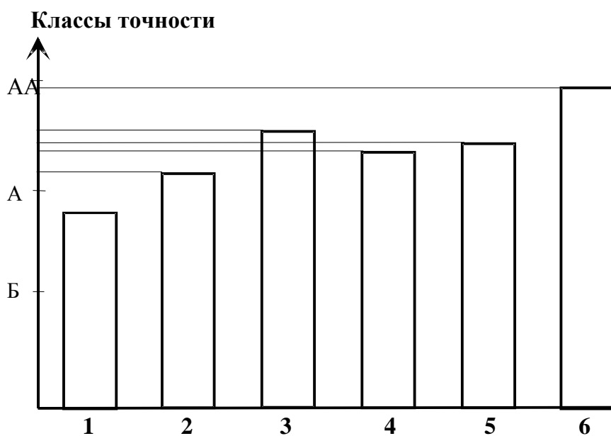
Рис.2 – Диаграмма влияния на точность изготовления шлифовальных кругов различных рассмотренных методов, схем и устройств: 1 – вибросмешивание, 2 – точная навеска, 3 – вращающаяся пресс-форма, 4 – качественный обжиг, 5 – мехобработка алмазными инструментами, 6 – совокупность методов.
