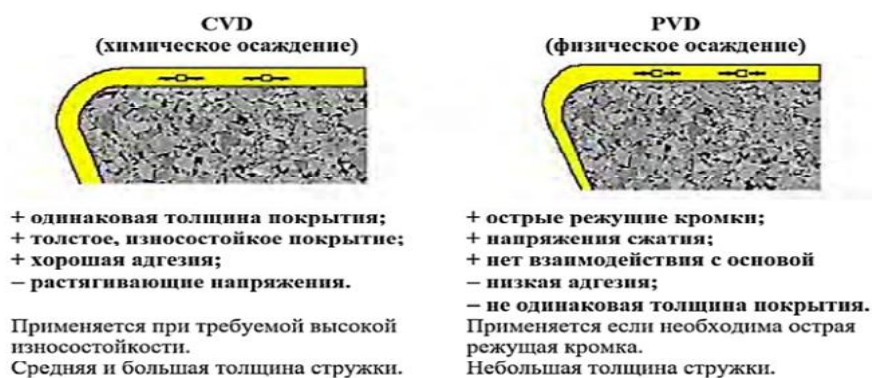
Рисунок 1. Сравнение методов CVD и PVD
