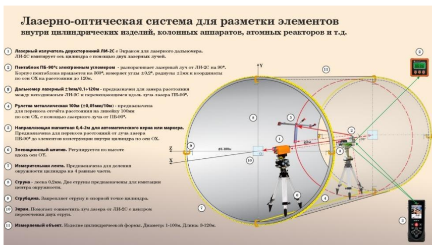
Рисунок 2 – Лазерно-оптическая система для разметки элементов внутри цилиндрических изделий
