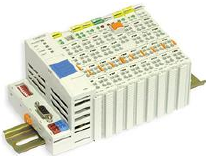
Рисунок 1 – Контроллер Fastwel CPM712 с модулями ввода вывода
