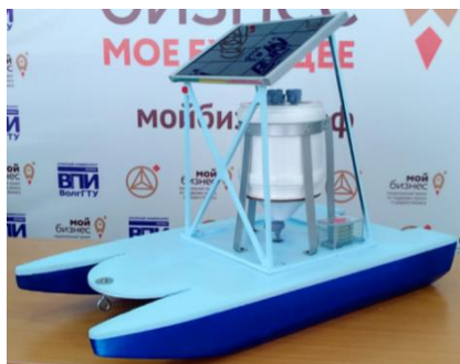
Рисунок 2 – Макет автоматического устройства вселения Chlorella vulgaris в природные и искусственные водоемы
