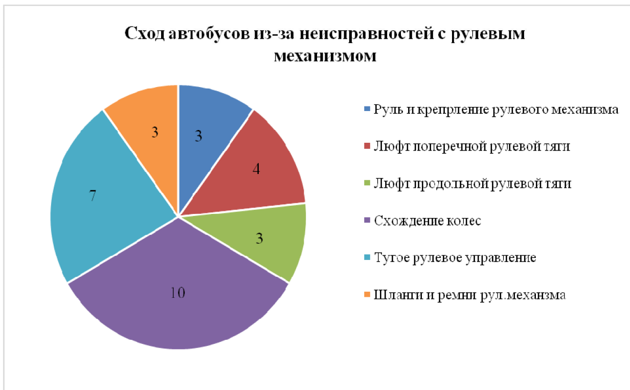
Рисунок 2. График сходов автобусов «Волгабас-5270GH» с ремонтом рулевого управления
