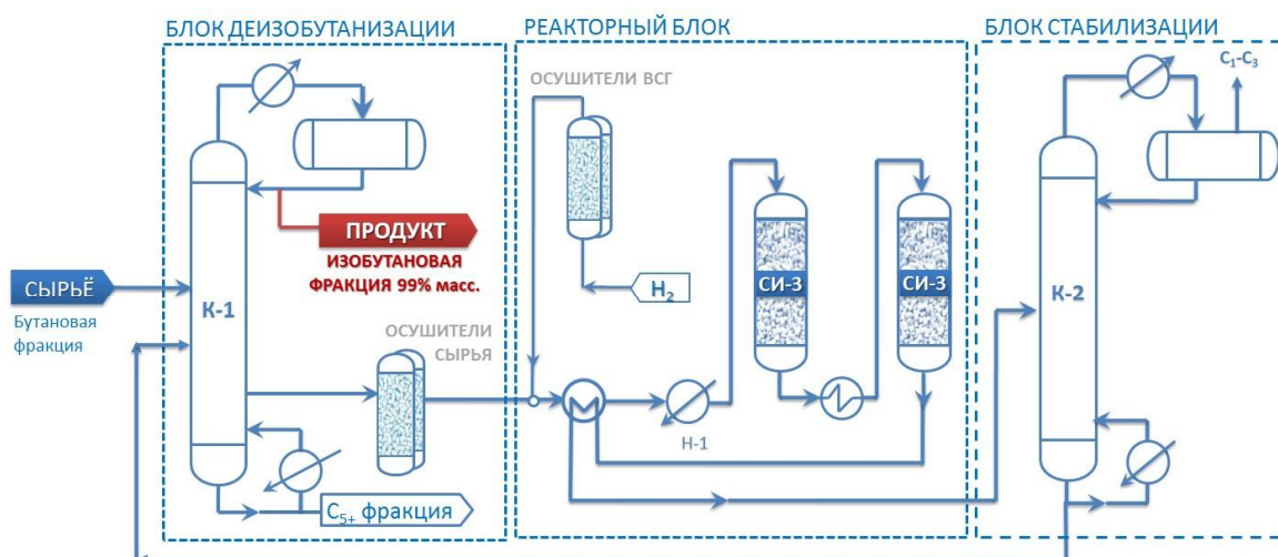
Рисунок 2. Принципиальная технологическая схема получения изобутанацеолитсодержащих катализаторов
