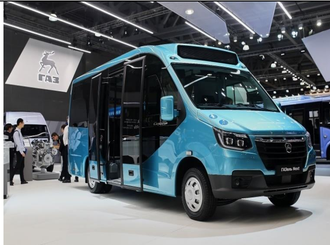
ГАЗель City 2021 А60R42-1073. Низкопольный. вместимость 22/18, двигатель Cummins (дизельный), Евро 4, 150 л.с., 2778200 руб.
