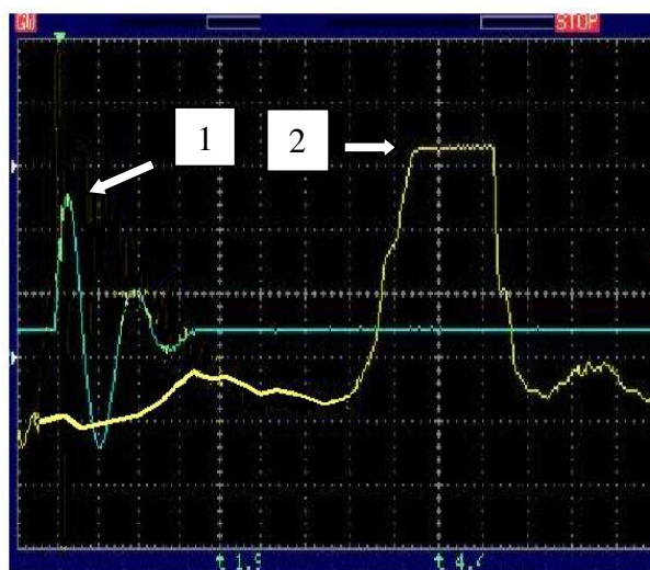
Рис. 1б Характерные осциллограммы разрядного тока -1 и кривая времени от-крытия фотодиода - 2
