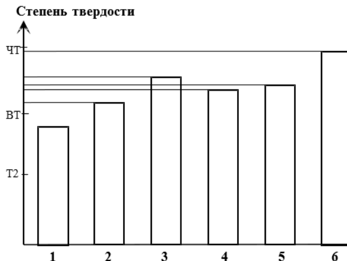
Рис. 2. Изменение степени твердости материала абразивных инструментов из электрокорунда F60 с плавящейся связкой K5 (1), K5C (2), с наполнителем 25AF220 (3), с дополнительным помолом связки (4), с дополнительным введением борного стекла (5), K5C с наполнителем, дополнительным борным стеклом и помолом (6)
