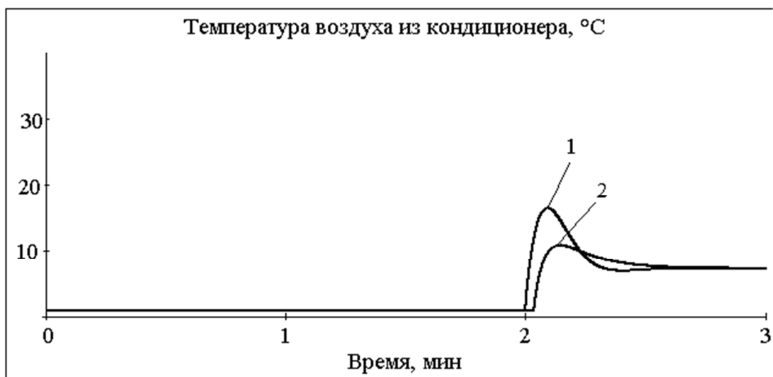
Рисунок 2 – Изменение управляющее воздействие: 1 - выработанное системой с адаптивным регулятором; 2 – выработанное системой с постоянным регулятором.
