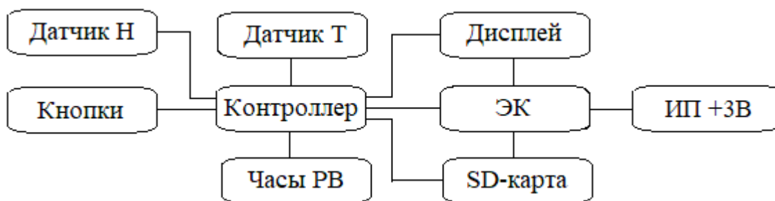
Рис.1. Структурная схема мобильного измерителя-регистратора влажности и температуры. ЭК – электронный ключ, ИП – источник питания, РВ – реальное время
