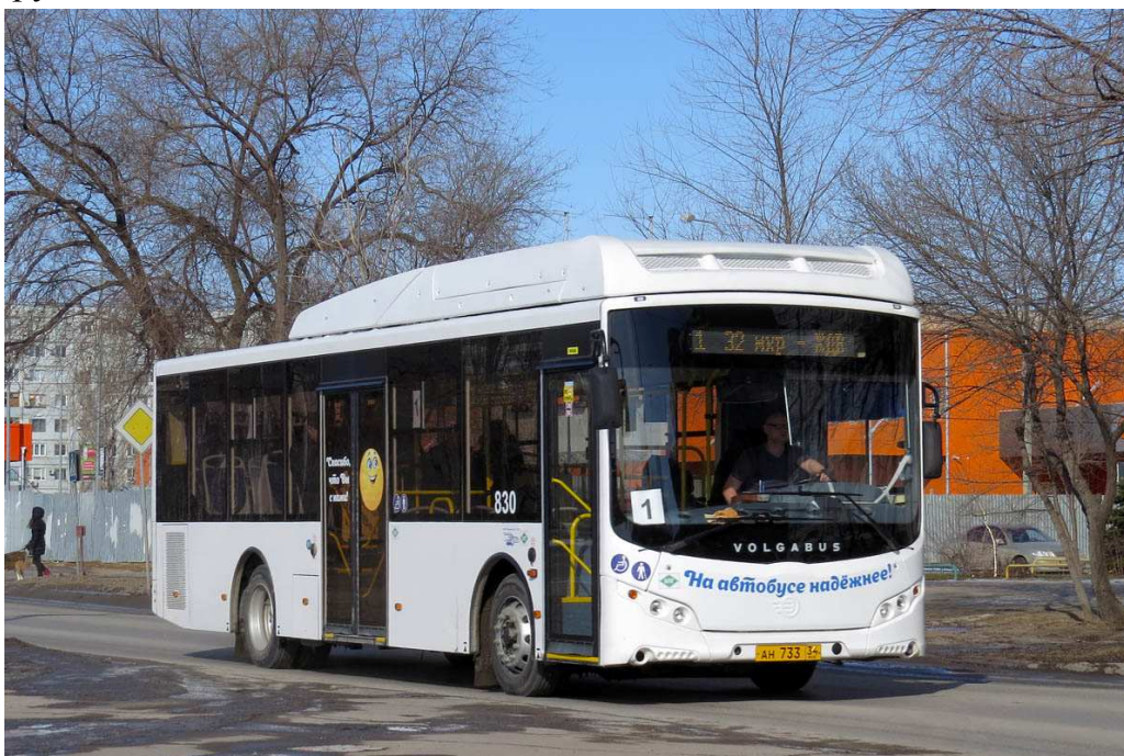
Рис. 1. Полунизкопольный автобус «Volgabus-5270GH» с колесной формулой «4×2»
