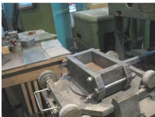
Рис. 3. Формовочная масса в пресс-форме (100×200)
