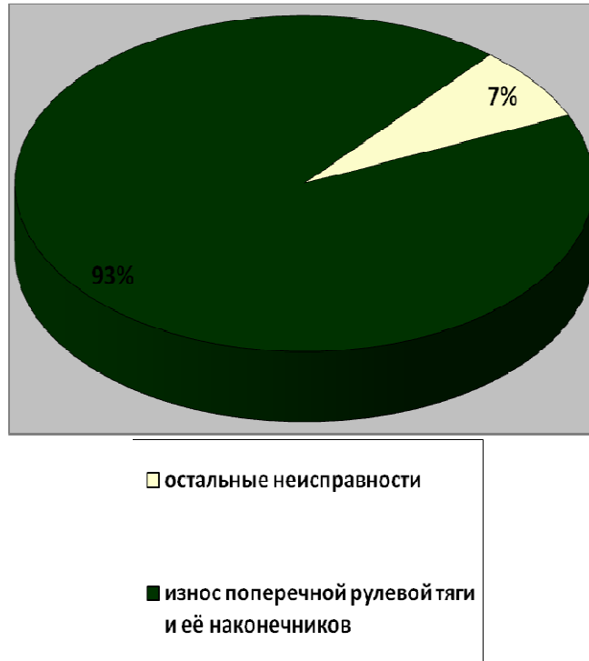
Рисунок 1. - Количество сходов с неисправностью рулевого управления, в процентном соотношении, автобуса модели «Волжанин-3290» и её модификаций.
