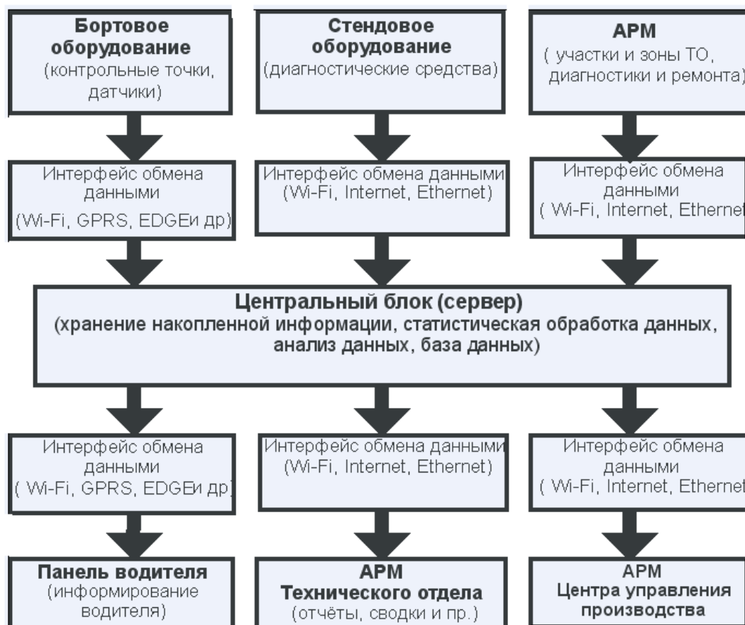
Рис. 1. Применение систем бортового контроля для оперативного контроля технического состояния автомобилей и оперативного управления производством.
