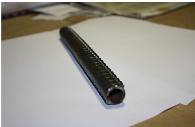
Рисунок 1 – Образец арматуры кольцевого поперечного сечения
