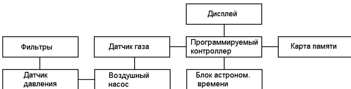
Рис.1. Структура системы управления и прибора.
