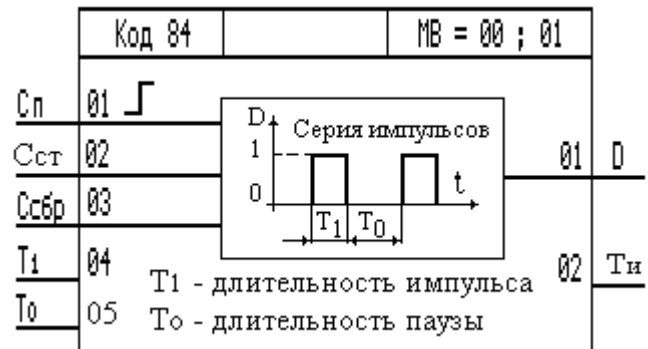
Рис. 13 – Алгоритм МУВ после модификации
