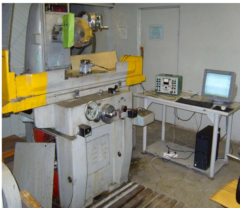
Рисунок 1 - Лабораторная установка на базе станка ЗГ71 с динамометром УДМ-100
