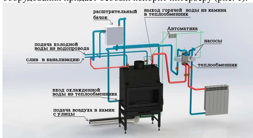
Рисунок 1 – Чугунная печь с водяным контуром.
