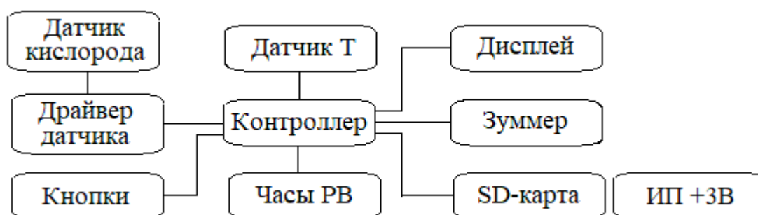
Рисунок 1 - Структура мобильного измерителя-регистратора уровня содержания кислорода в воздухе
