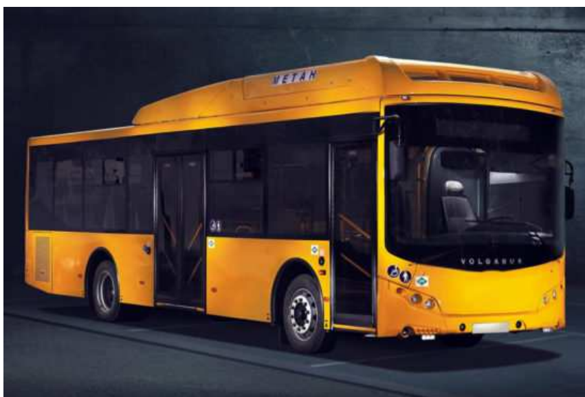
Рис. 1. Полунизкопольный автобус «VolgaBus-5270GH» на моторном топливе метан.
