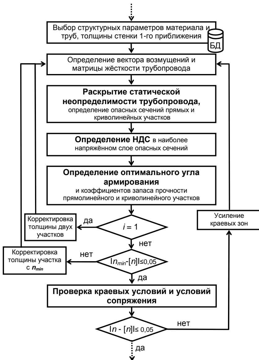
Рисунок 3 - Алгоритм расчёта при создании рабочего проекта трубопровода
