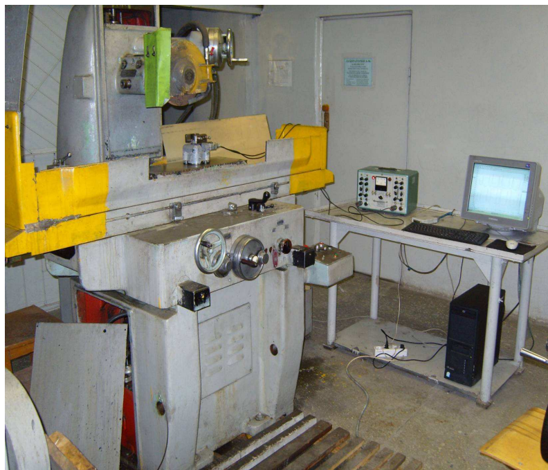
Рисунок 1 - Лабораторная установка на базе станка 3Г71 с динамометром УДМ-100
