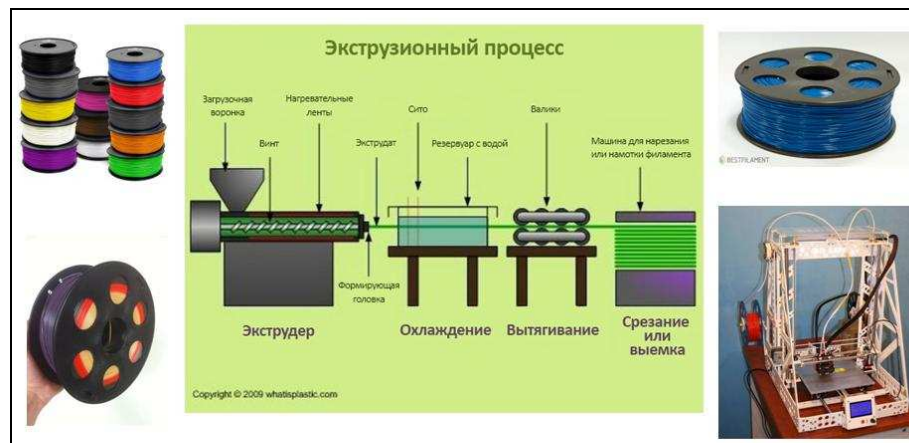
Рис. 4 – Процесс создания филамента для FDM 3D-печати
