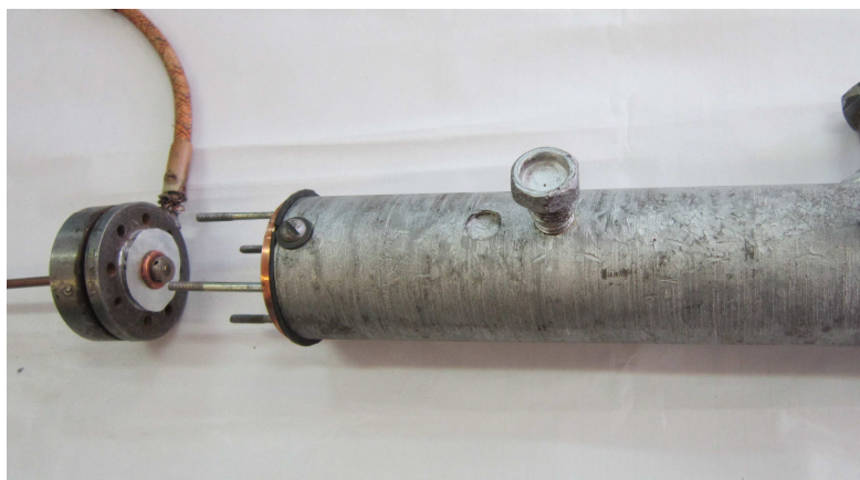
Рисунок 2 - Внешний вид цилиндрической разрядной камеры и электродной системы, обеспечивающей возможность протекания разрядного тока в радиальном направлении и организацию самоприжатого разряда
