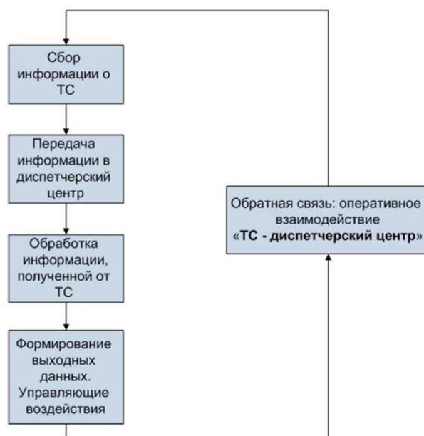
Рис. 2. Укрупненная схема технологии автоматизированного диспетчерского управления транспортом.
