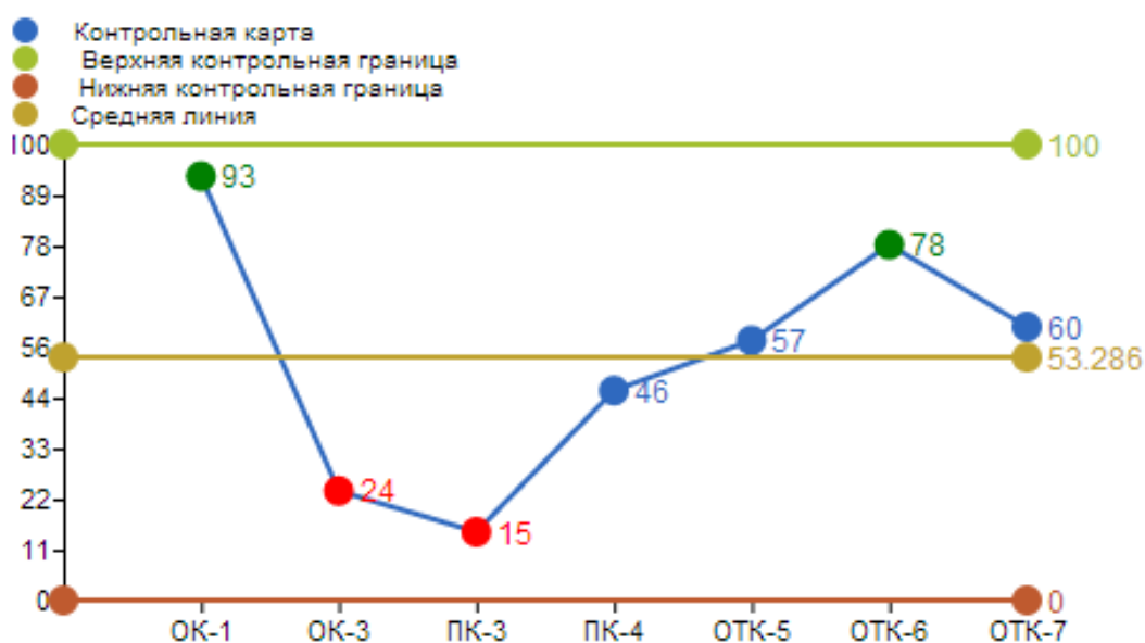
Рис.1. Визуализация X-контрольной карты с помощью библиотеки gRaphael
