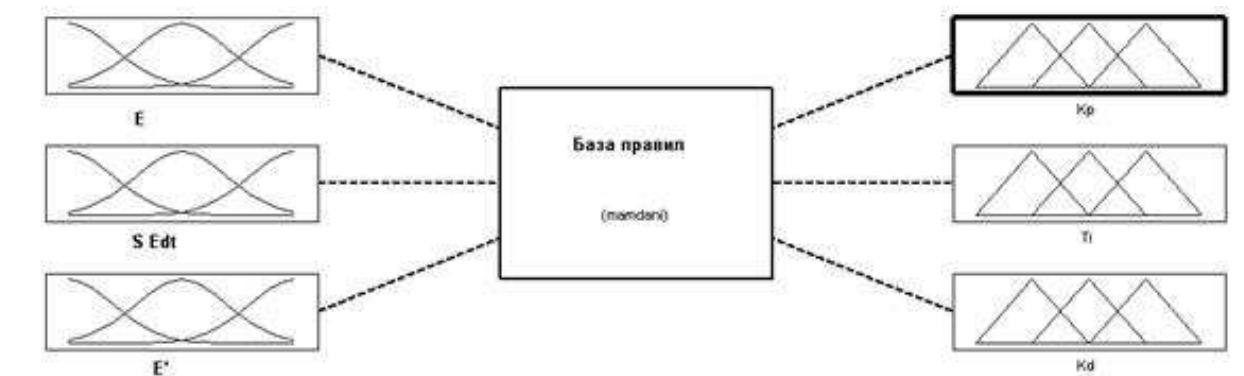
Рис. 5. Графический интерфейс редактора FIS
