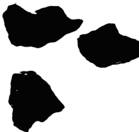
Рисунок 2 – Фотография абразивных зерен карбида кремния черного фракции F46, сделанная камерой 5 Мпикс на увеличении 1 микроскопа МБС-9
