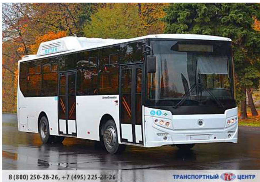
Рис. 4. Газовый КАВЗ-4270 GNG, вместимостью 84 пассажира (27 мест + 1 место для людей с ограниченными возможностями).
