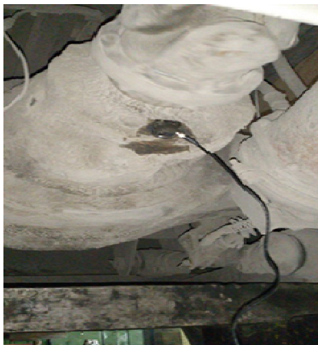
Рис. 1. Крепление датчика на корпусе заднего моста.
