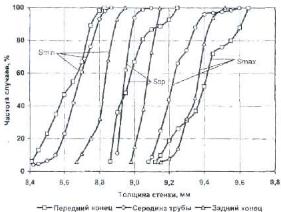
Рис. 2. Кривые распределения толщины стенки черновых редуцированных труб размером 75,4x9,4 (73,5x7,9) мм [5]
