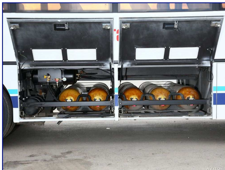
Рис. 2. Пример установки метановых баллонов под полом автобуса.
