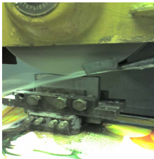
Рисунок - Станок 3Г71 ( а ) с установленным динамометром УДМ-100 ( б )
