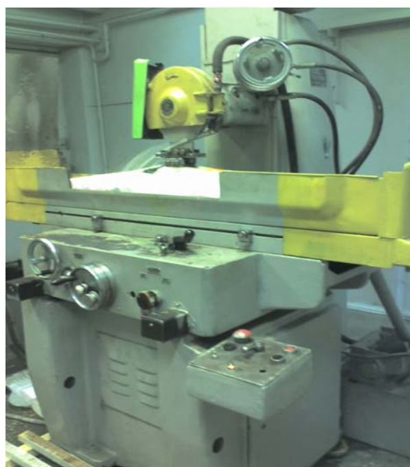
Рисунок - Станок 3Г71 ( а ) с установленным динамометром УДМ-100 ( б )
