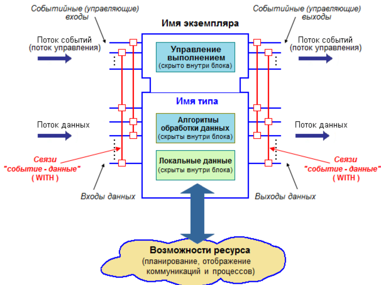
Рис.2. Характеристики базисного функционального блока
