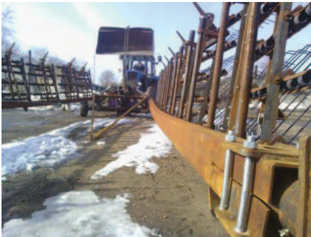
Рисунок 3 – Деформация балки бороны пропалочной с пружинными зубьями КАКТУС 24П с исходной конструкцией крыла – а; усиленная конструкция крыла бороны - б
