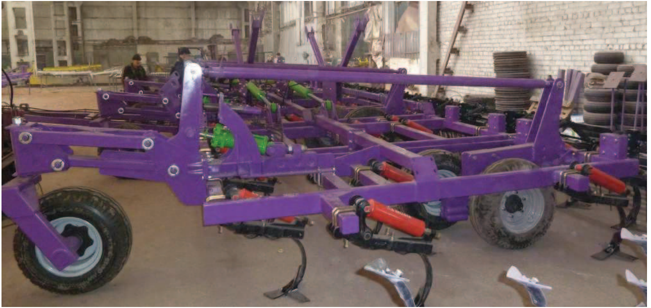
Рисунок 5 – Усовершенствованная конструкция культиватора «Уникс-12»
