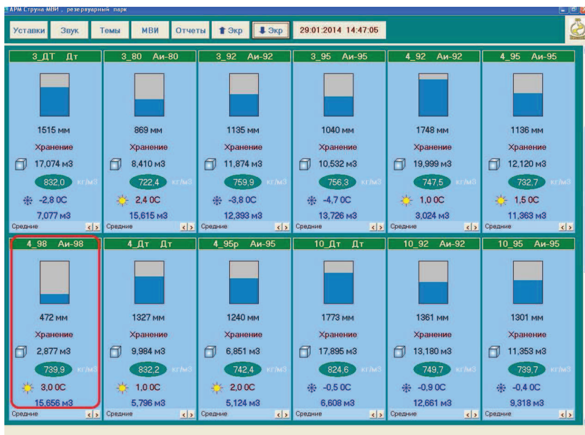
Рис. 3. Рабочий интерфейс системы мониторинга остатков топлива в резервуарах АЗС
