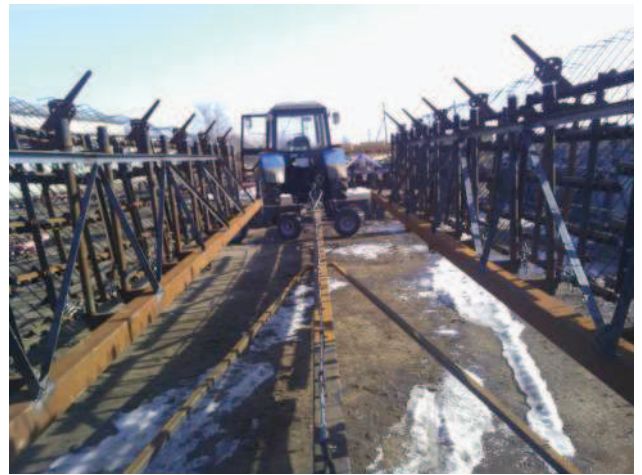
Рисунок 3 – Деформация балки бороны пропалочной с пружинными зубьями КАКТУС 24П с исходной конструкцией крыла – а; усиленная конструкция крыла бороны - б
