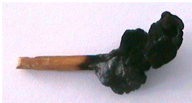
Рис.4. Образование коксовой шапки на древесине, обработанной фосфорборсодержащим антипиреном, после воздействия открытого пламени
