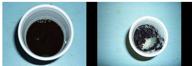
Рис. 1. Действие сорбента по сбору дизельного топлива (сразу после добавления сорбента и через 20 мин.)
