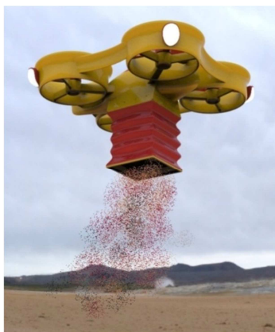
Рис.5.9. БПЛА с раскрытой подающей трубой во время сброса огнетушащего материала
