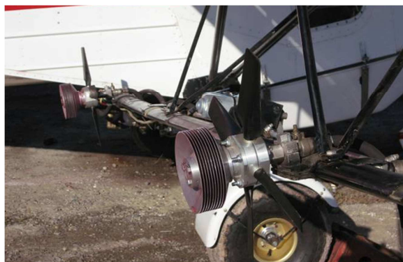
Рис.5.5. Прототип навесной аппаратуры капельного распыления предприятия «НТК»
