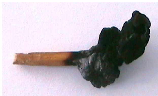
Рис.5.6. Образование коксовой шапки на образце древесины, обработанной ФБО после воздействия открытого пламени
